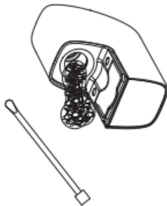
2. Material aus der Kammer entfernen
